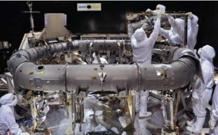
Integración del primer espejo primario en el módulo de carga
