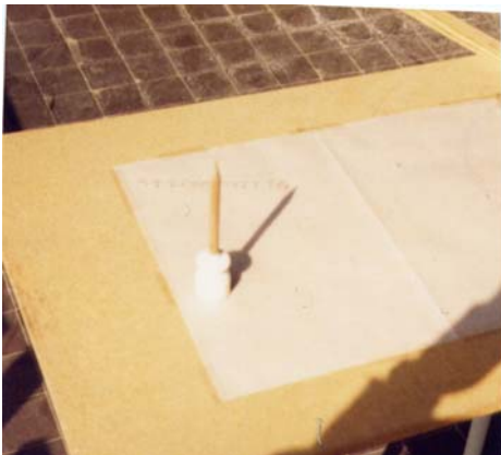
Fig. 7.- El gnòmon en funcionament. Fig. 8.- Registre d'unes quatre hores de la posició de l'ombra. S'ha anat marcant l'extrem de l'ombra.
